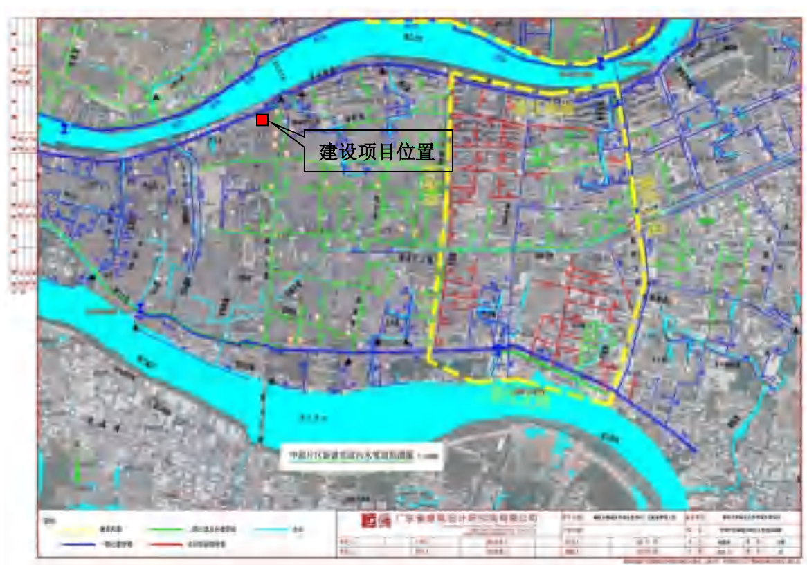
图 6.2-2 污水处理厂污水管网分布图
